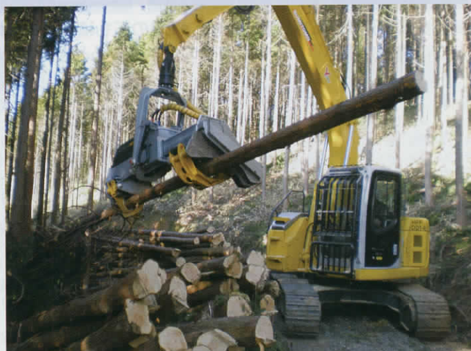
作業道脇に集積された材木を重機で掴み送りながら枝払いと玉切りを行います。
